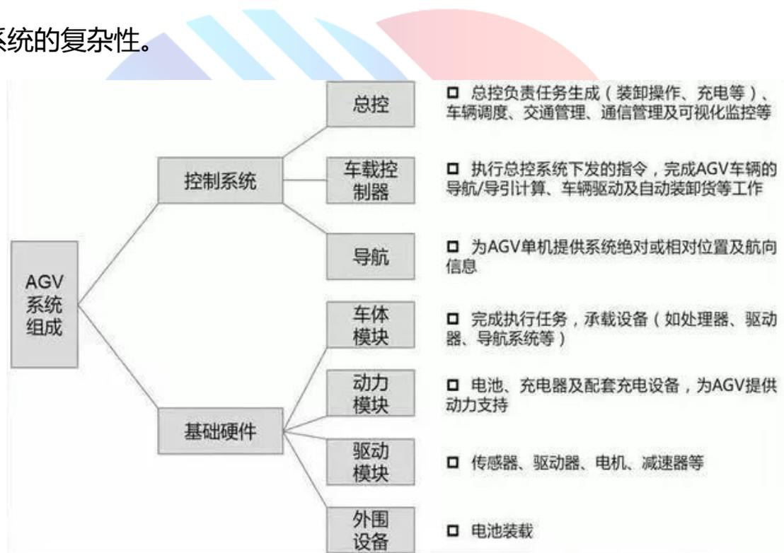
**图 7 自动导引车 (AGV) 系统组成图示**
